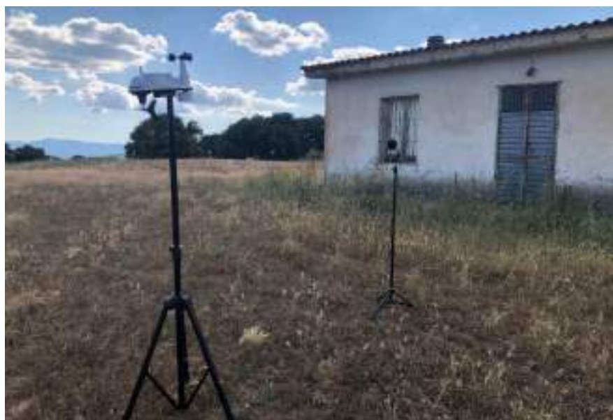
Figura 7: Dettaglio posizione microfono e centralina meteo
