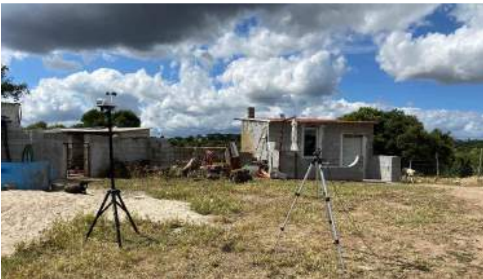
Figura 11: Dettaglio posizione microfono e centralina meteo
