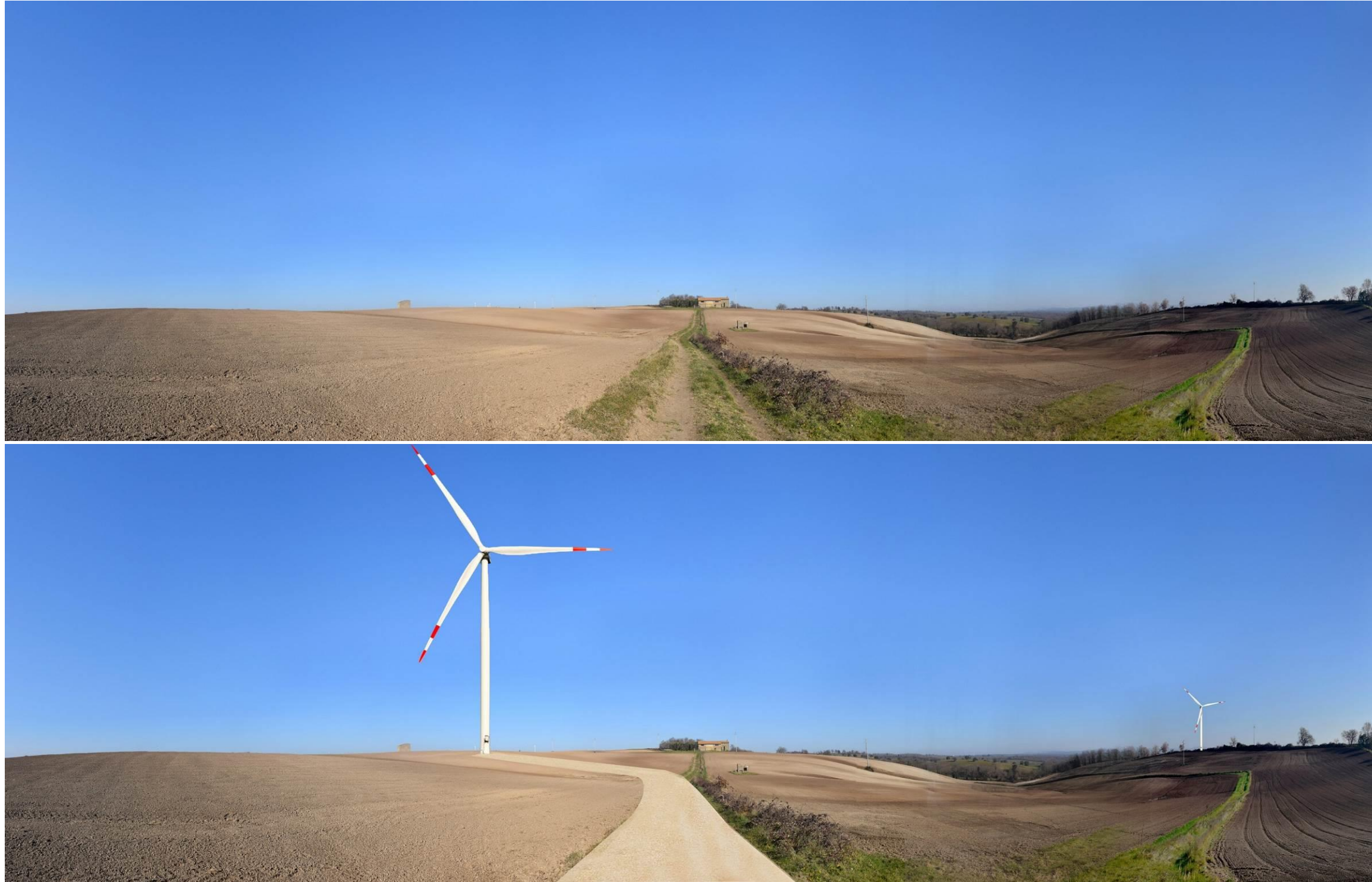
Figura 14 Panoramica 19 _ Vista dalla strada comunale che attraversa il Sottocampo Nord composto da 10 WTG, a 250 m dalla WTG A14 Nell'immagine in alto, lo stato di fatto. Nell'immagine in basso, fotoinserimento verso le WTG A14 (a sinistra) e A15, con in evidenza la tipologia utilizzata per la viabilità di servizio
