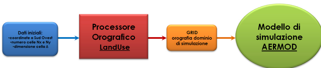
Figura 3.1.2-1: Diagramma di flusso per la realizzazione dell'orografia per il modello di simulazione BREEZE AERMOD.
