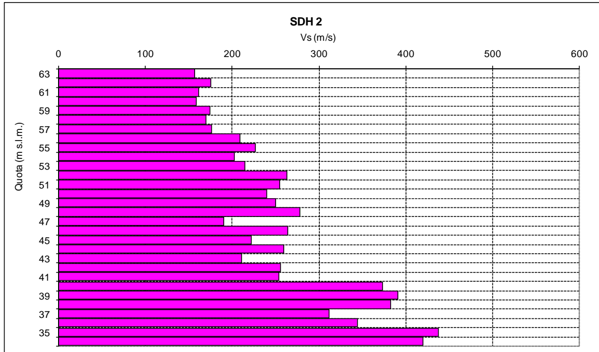
Figura 3.6.4 Down-Hole eseguito nel foro di sondaggio SDH 02. Velocità d'intervallo per le onde di taglio
