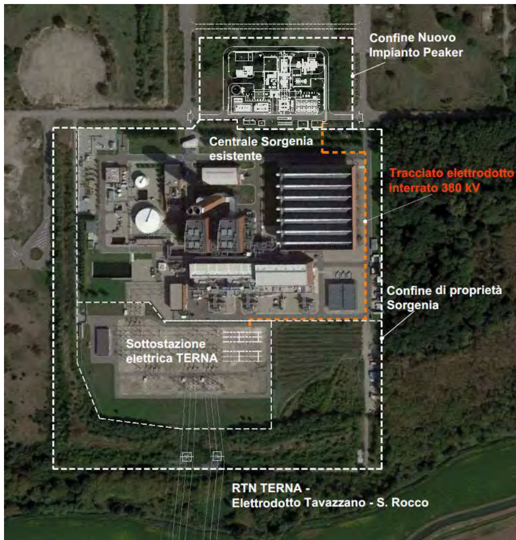
Figura 3-14: Tracciato elettrodotto interrato 380 kV
