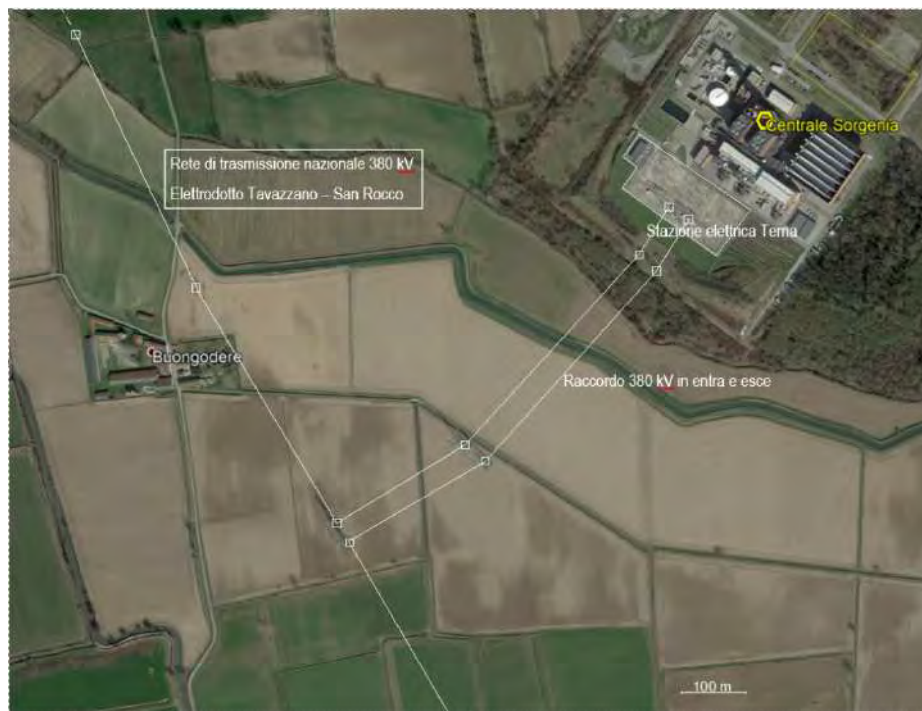
Figura 4-75: Raccordo della Stazione Terna alla Rete di Trasmissione nazionale
