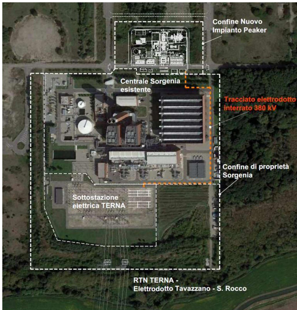
Figura 32: Tracciato elettrodotto interrato 380 kV
