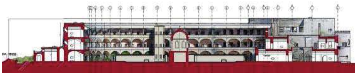
Fig. 2 – Prospetto sezione corpo centrale dell'ex Carcere, corpo di guardia, cortile del Panottico con le celle
