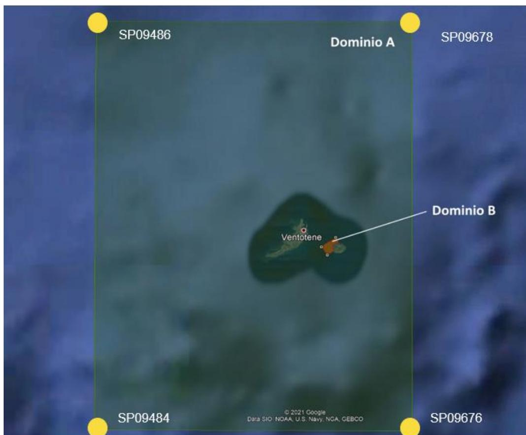
Figura 3-1 Estensione dei domini di calcolo (A e B) utilizzati per il *downscaling* spettrale di moto ondoso
