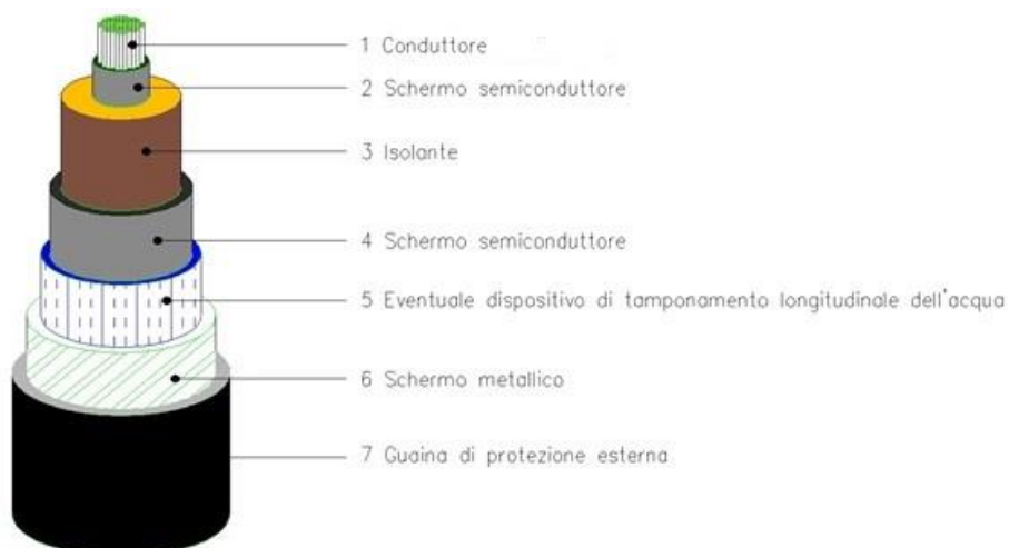
Figura 4.2: Sezione tipo cavo interrato
