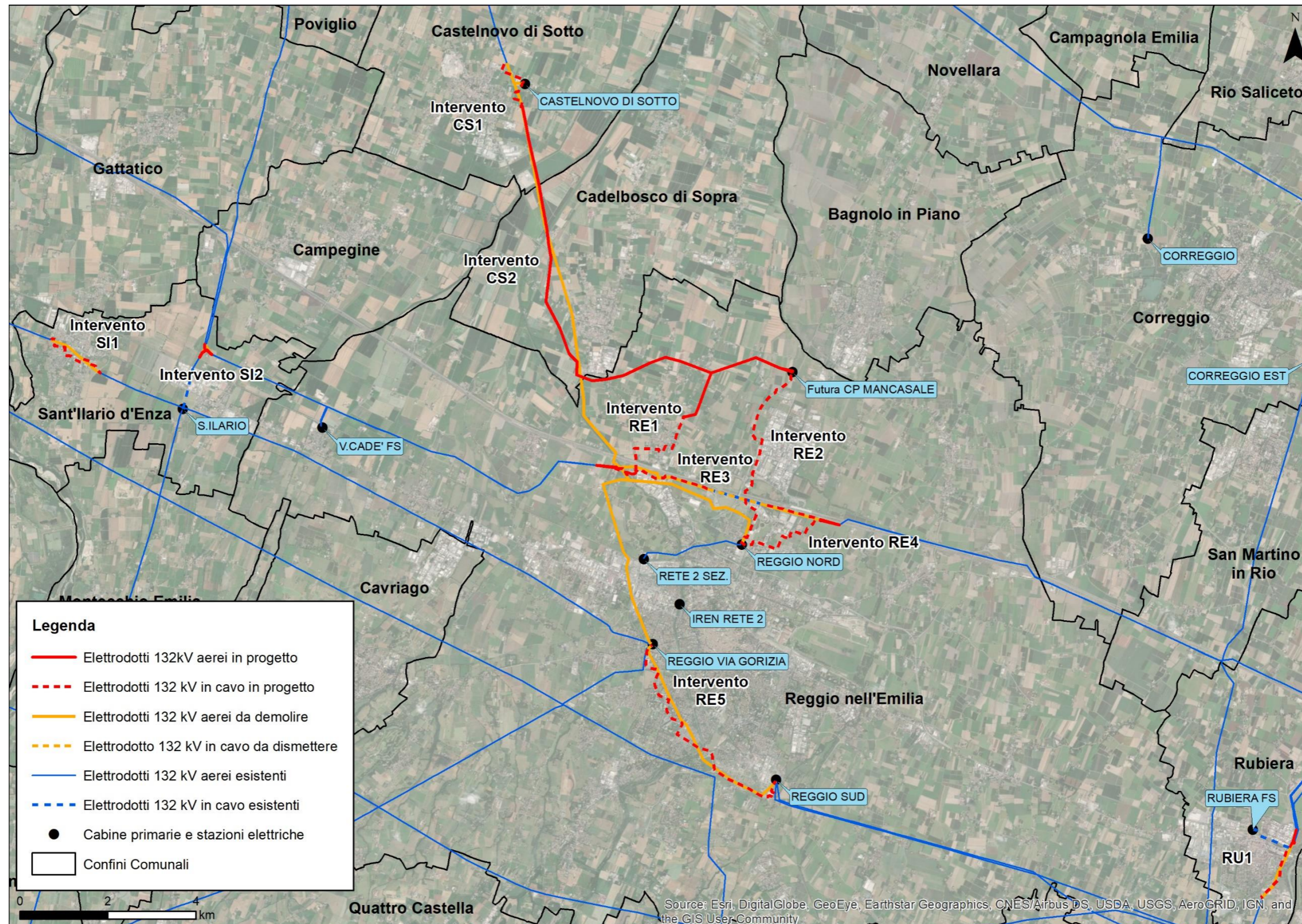
Figura 3.2: Localizzazione degli interventi in progetto
