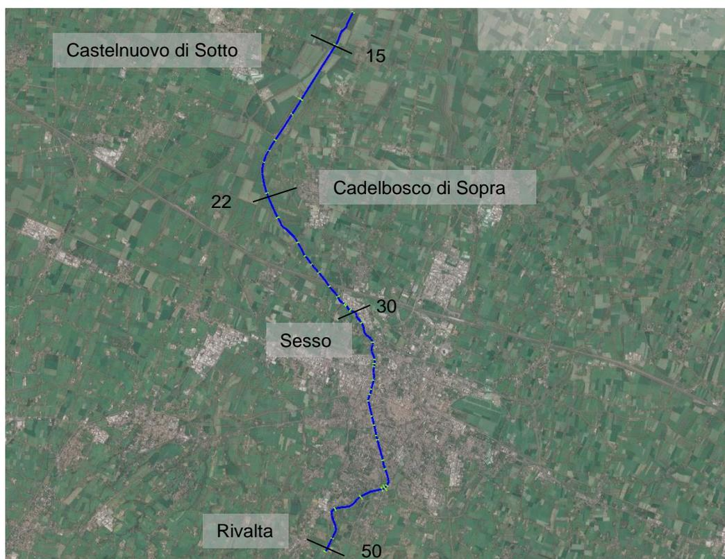
**Figura 4–3: Tratto del torrente Crostolo oggetto di verifica idraulica ed ubicazione delle sezioni trasversali di rilievo**
