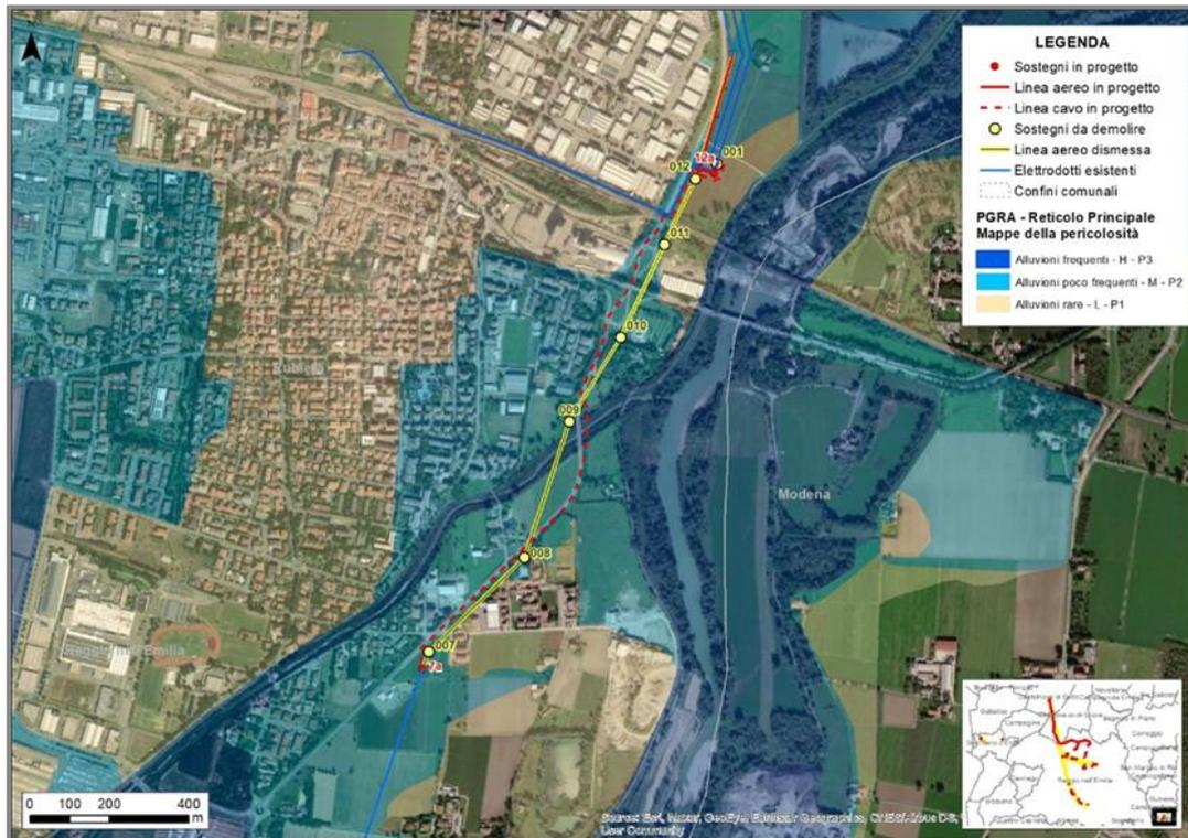
**Figura 3–12: Particolare dell’interferenza del progetto in esame con le zone P3 e P2 nel territorio di Rubiera (Fonte dei dati: PGRA - mappe della pericolosità del Reticolo principale di pianura e di fondovalle).**
