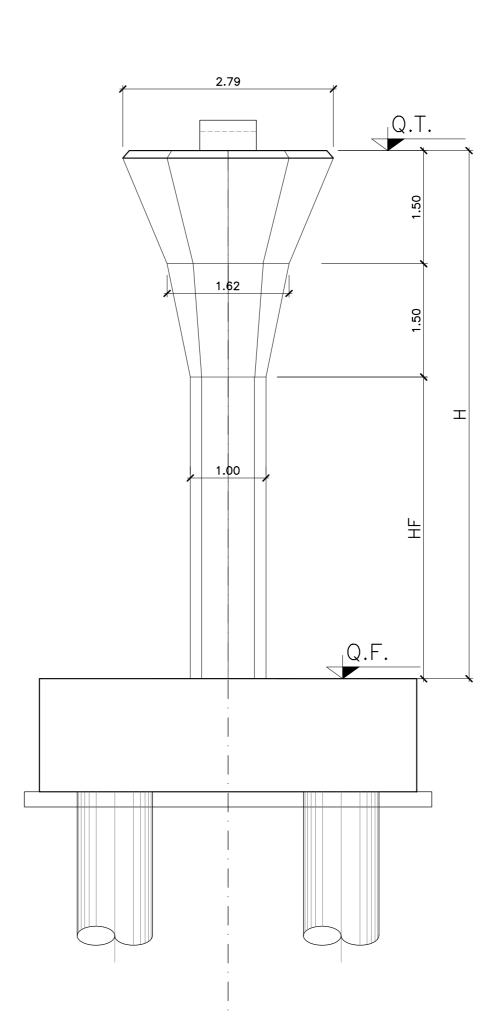
INCIDENZA ACCIAIO PILE 110Kg/m³ PLATEA DI FONDAZIONE 140Kg/m³ ELEVAZIONE 120Kg/m³ PULVINO 400Kg/m³ BAGGIOLO/RITEGNO
