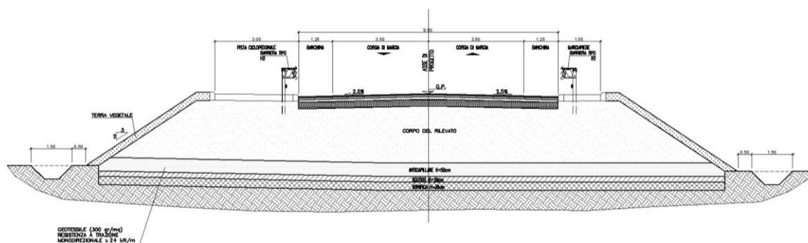
Figura 7: Sezione tipo strada C2 con pista ciclopedonale
