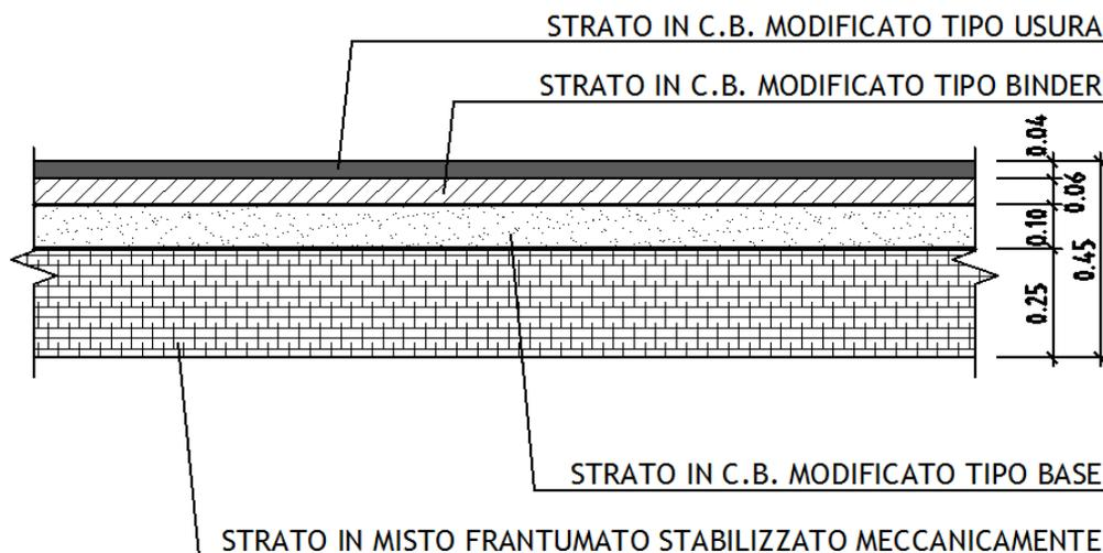
Figura 8: Particolare pavimentazione strada categoria C2
