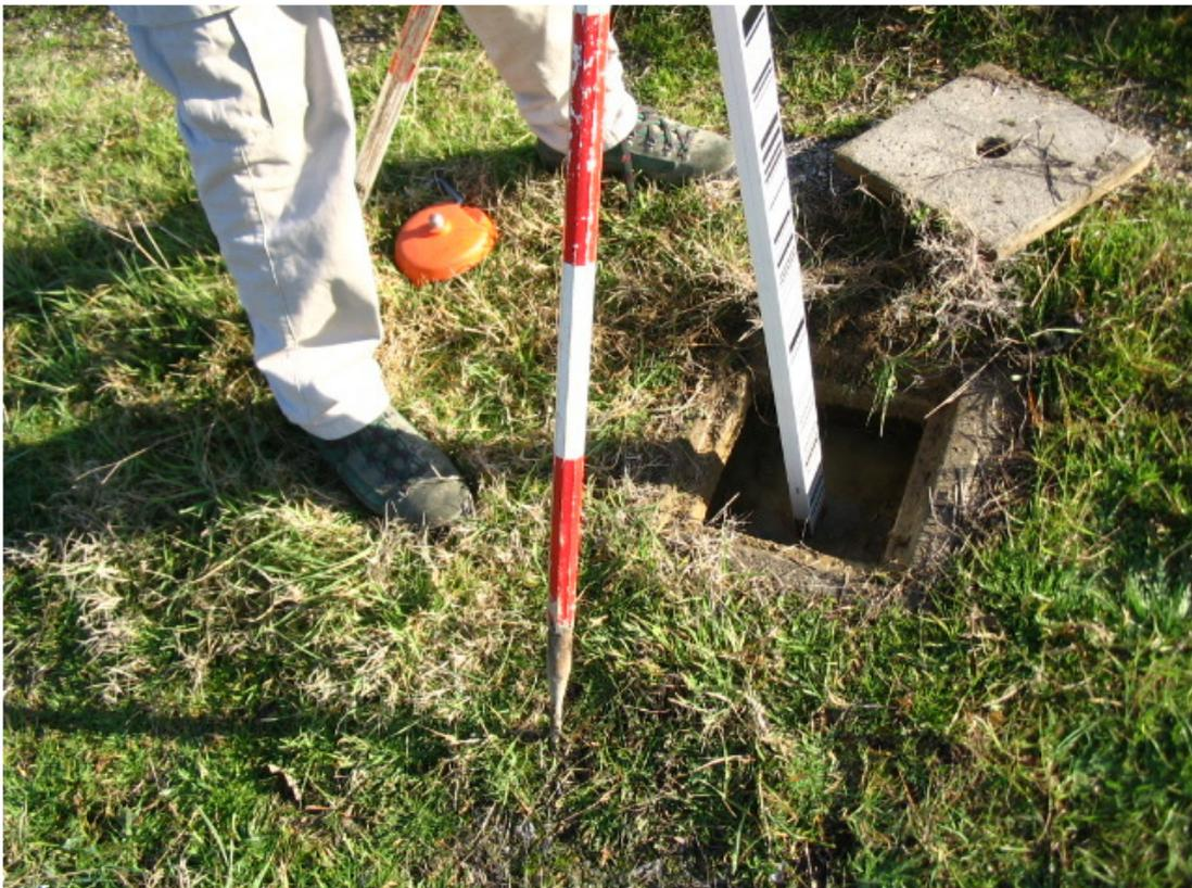
Fig. 14: pilastro di misura sul coronamento della diga
