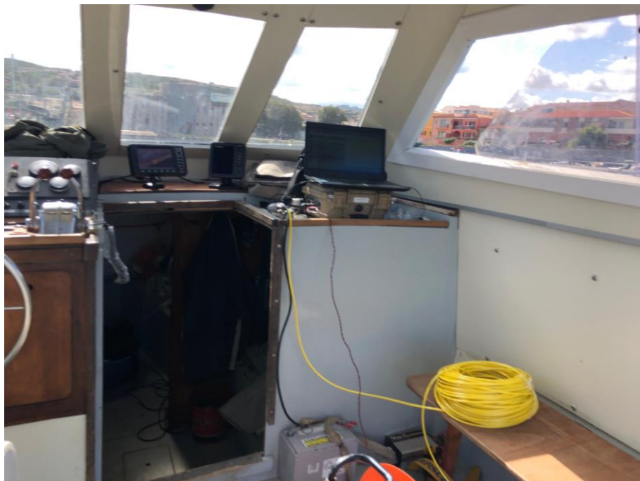
Unità base di acquisizione segnale (sismografo) ubicato su mezzo natante
