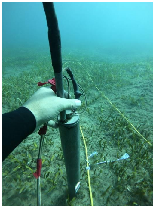
Particolare dell'energizzazione eseguita direttamente su fondale marino con energizzatore costituito da un maglio a sgancio rapido
