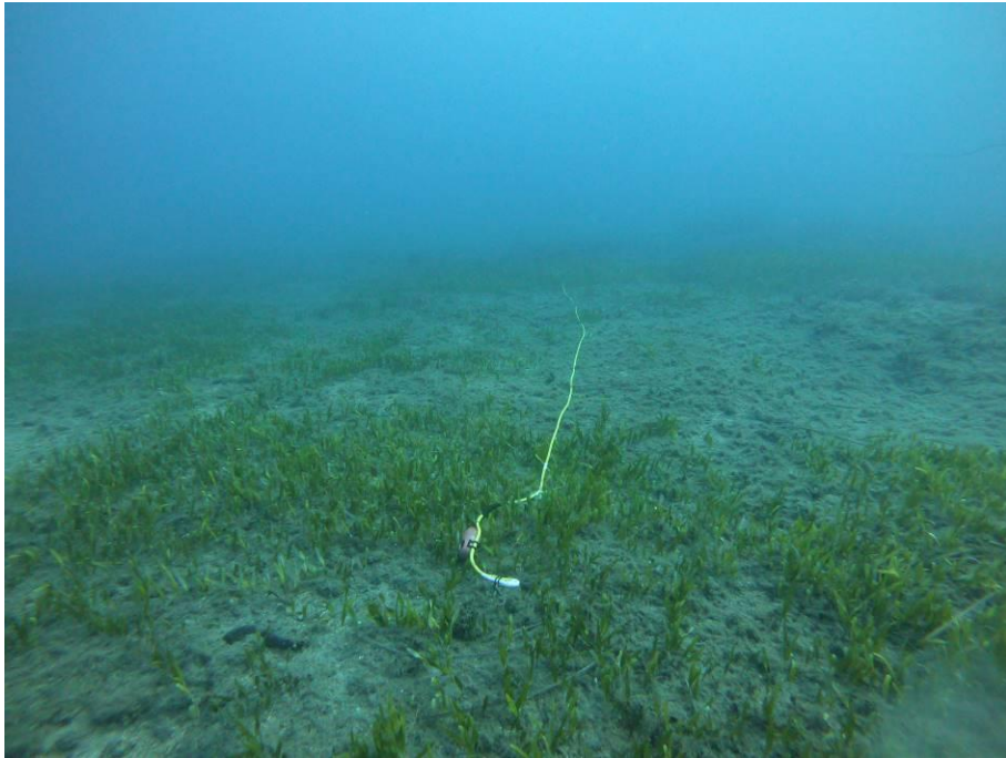
Particolare della sistemazione della catena idrofonica su fondo sub pianeggiante con scarsa copertura vegetativa
