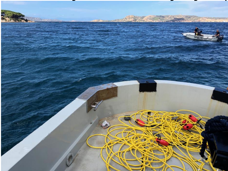
Catena idrofona utilizzata in fase di sistemazione sul fondo ad opera di SUB
