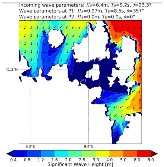
Figura 6 – penetrazione mareggiate NW - P1 e P2
