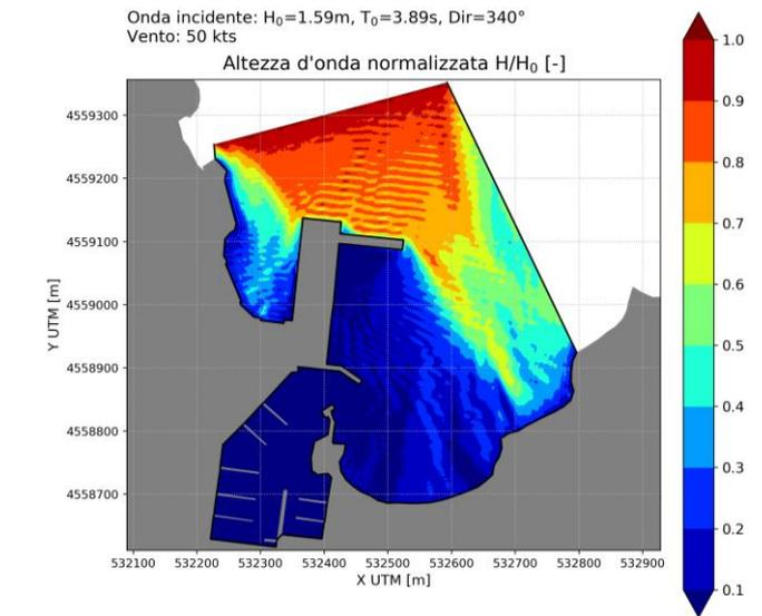
**Figura 27 - Situazione senza intervento** –altezze d’onda sugli specchi acquee in condizioni di picco per venti IV quadrante. . (Scala di lettura della barra laterale in  $[H_i/H_0]$ )
