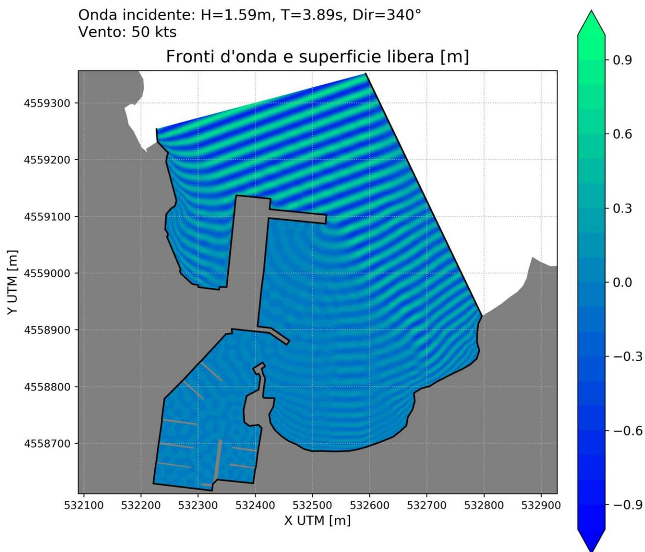
Figura 16 - Situazione con intervento -piano d'avanzamento dei moti ondosi associati alla traversia NW (Spargi
