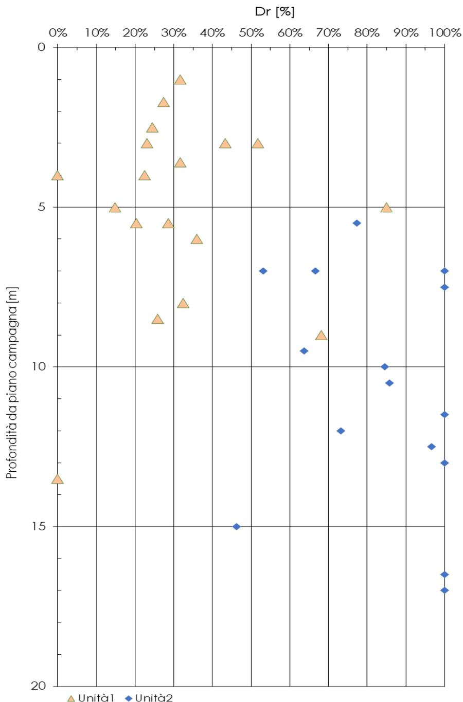
Figura 8-3: Densità relativa da standard penetration test.
