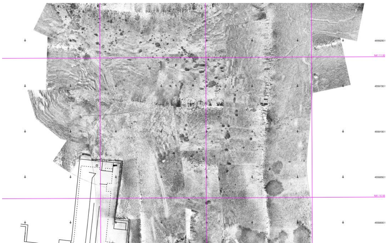
Figura 40: immagine ricavata dal rilievo side scan sonar
