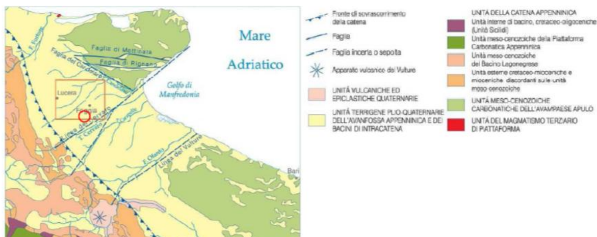
Figura 4-2 Schema strutturale regionale dei rapporti fra il dominio di Avanfossa, il dominio di Catena e quello di Avampaese (da Note Illustrative della Carta Geologica d'Italia)
