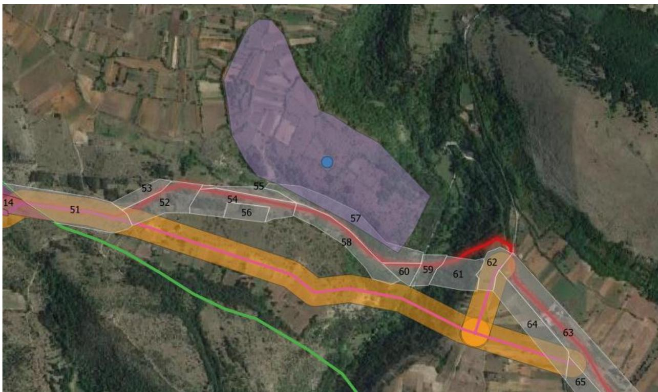
Figura 4 - Varianti B-LP e C-OC: area di intervento a Barisciano con indicazione dell'area di indagine (scala 1:10000): in arancione il *buffer* di ricognizione, in rosa le varianti al metanodotto in progetto, in rosso il tracciato del Tratturo Regio da IGM, in grigio le UR VI Arch 2020, in viola l'area di interesse archeologico di Furfo segnalata dalla VI Arch 2020, in verde i limiti comunali.
