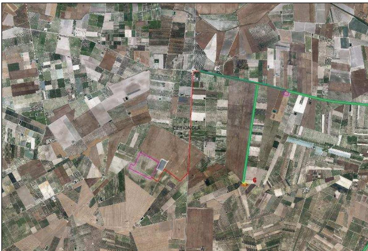
Fig. 7 - Dettaglio dell'area del tracciato del cavidotto esterno (in rosso) e della stazione elettrica (in fucsia) su base Ortofoto 2019 SIT Regione Puglia. In verde scuro la viabilità da adeguare.
