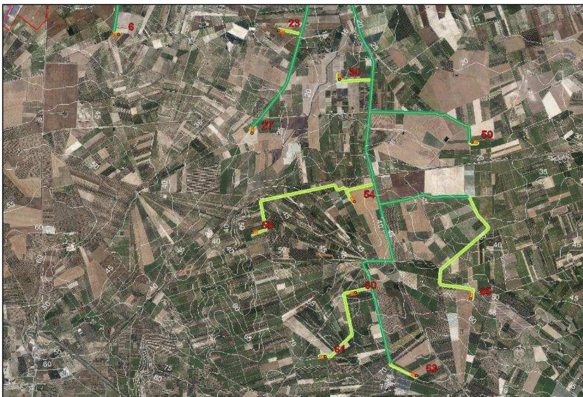
Fig. 9 - Dettaglio dell'area del parco eolico (in verde e rosso) su base Ortofoto 2019 SIT Regione Puglia con le isoipse (in bianco). In verde scuro la viabilità da adeguare, in verde chiaro quella da realizzare ex-novo.
