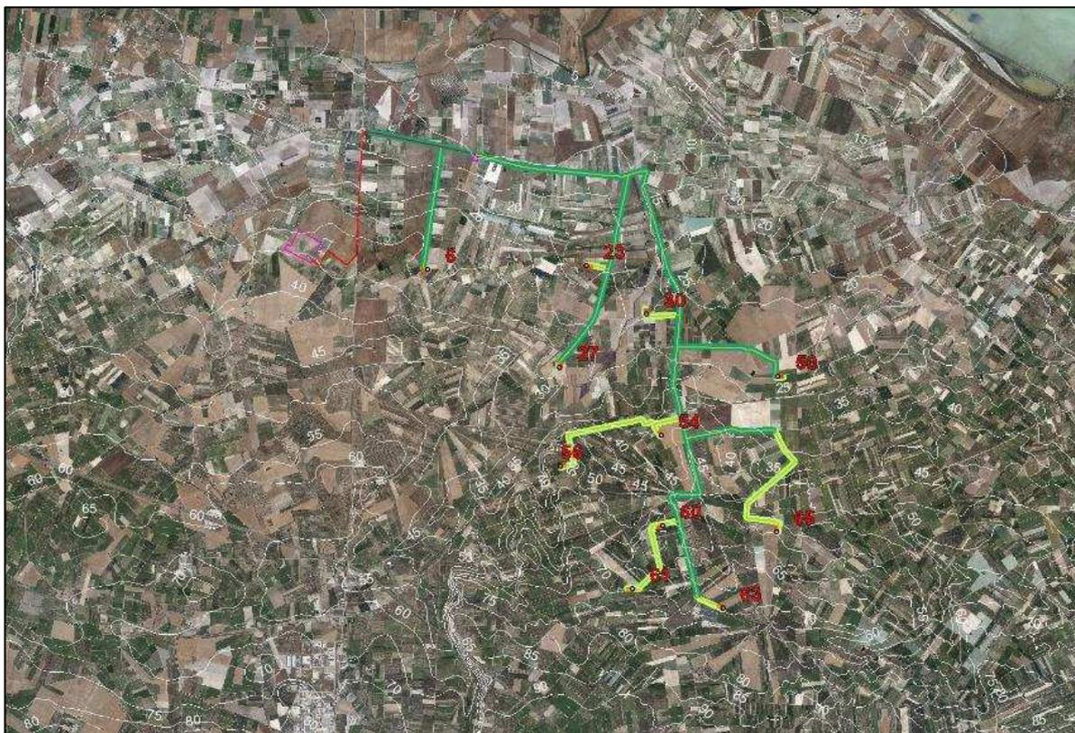
Fig. 8 - Localizzazione delle opere in progetto (in rosso, fucsia e verde) su base Ortofoto 2019 SIT Regione Puglia con le isoipse (in bianco). In verde scuro la viabilità da adeguare, in verde chiaro quella da realizzare ex-novo.
