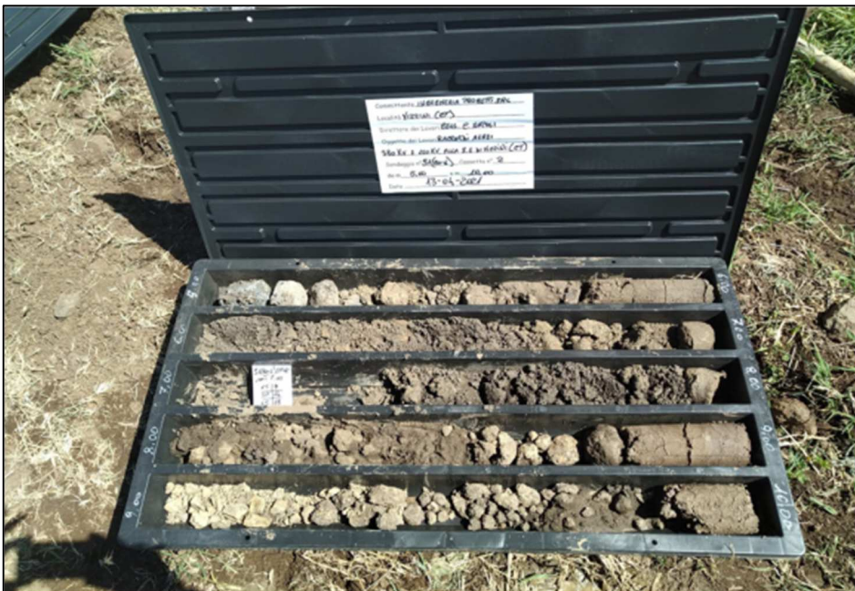
Sondaggio n° 1 (80 Cassetta Catalogatrice n° 2 da 5,00 m 10,00
