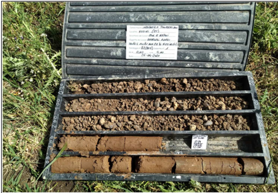
Sondaggio n° 2 (80 Cassetta Catalogatrice) n° 1 da 0,00 m 5,00
