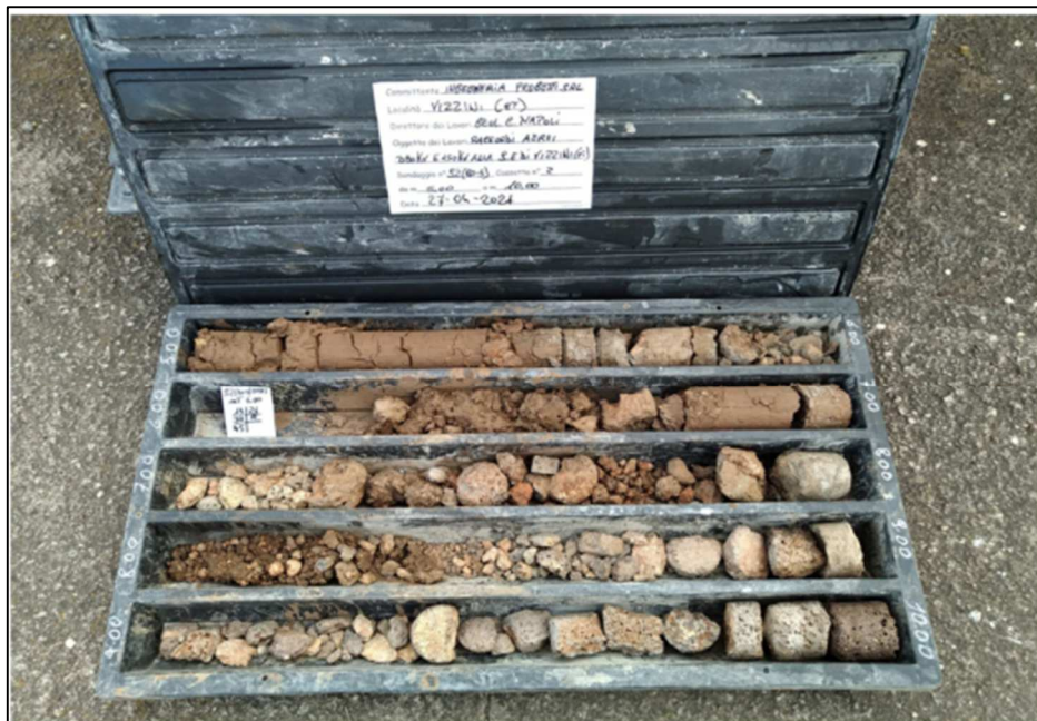
Sondaggio n° 2 (80 Cassetta Catalogatrice) n° 2 da 5,00 m 10,00
