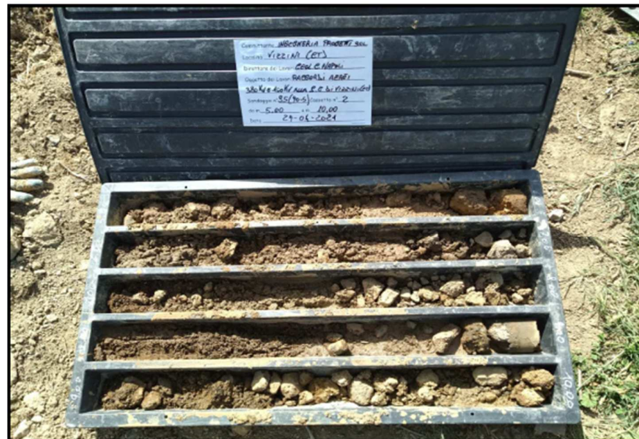
Sondaggio n° 5 (90 Cassetta Catalogatrice) n° 2 da 5.00 m 10.00
