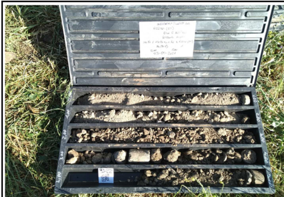
Sondaggio n° 4 (90 Cassetta Catalogatrice) n° 1 da 0,00 m 5,00
