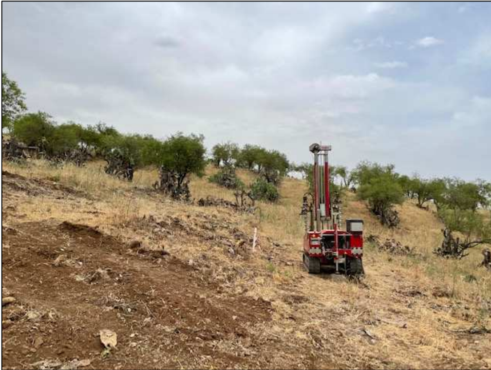
Figura 2 Foto DPSH sostegno 90-8
