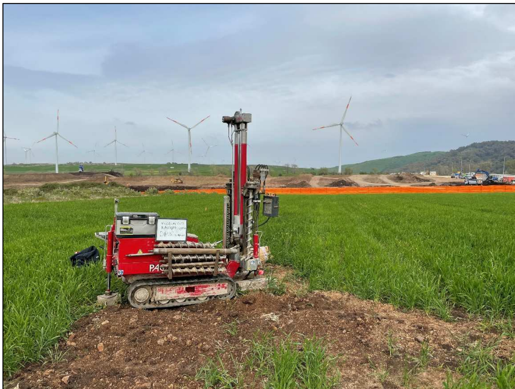
Figura 2 Foto DPSH sostegno 90-10
