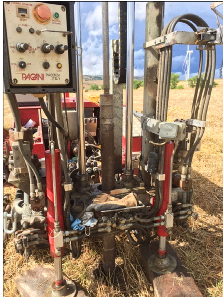
Fig 5 Esempio di campionatore da 60 mm
