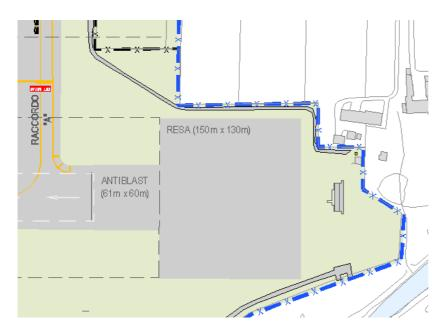
Fig. 55 - Sistemazione della Runway End Safety Area in testata 25
