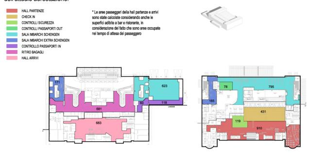
Fig. 65 - Schema di ampliamento e distribuzione delle aree passeggeri - Aerostazione 2011
