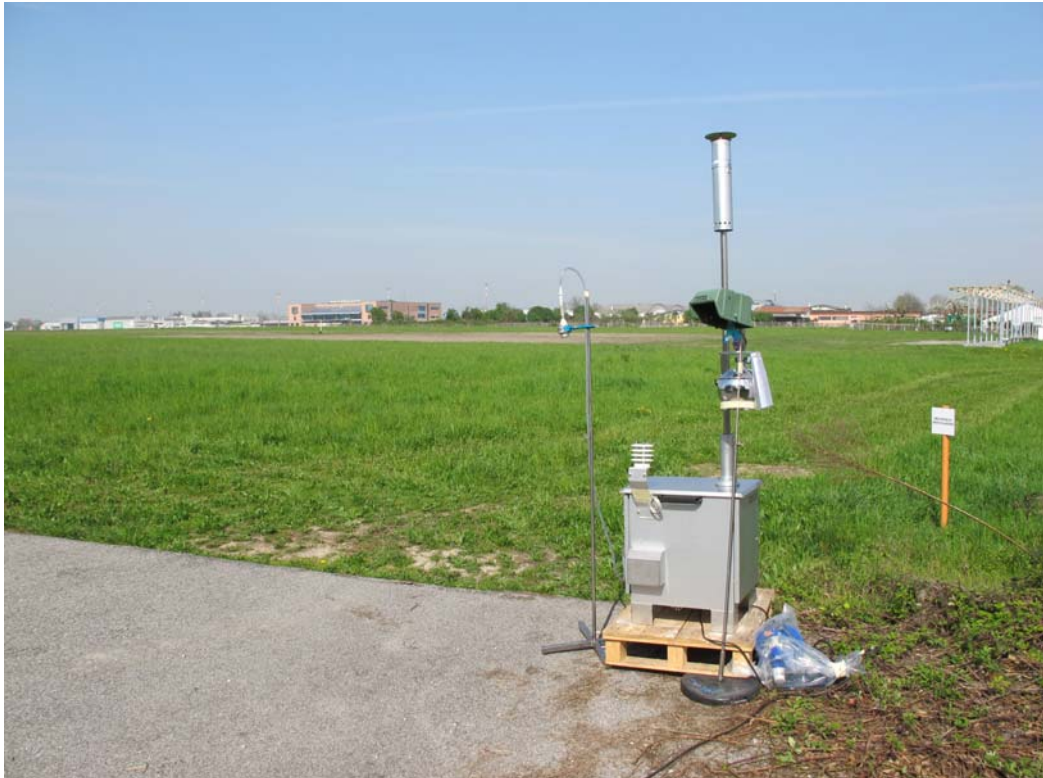
Figura 1-3 Centralina utilizzata per il prelievo di polveri sottili (PM 10 ) e polveri totali (PTS). Nella foto posizionamento in testa pista (posizione n.1).
