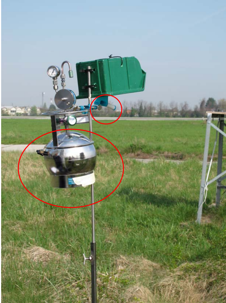
Figura 1-2 Strumentazione di campionamento utilizzata: canister (in basso) e radiello (in alto). Nella foto il posizionamento a bordo pista (postazione n.2).
