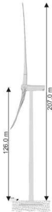
VISTA LATERALE AEROGENERATORE E TORRE EOLICA TIPO_Scala 1:500
