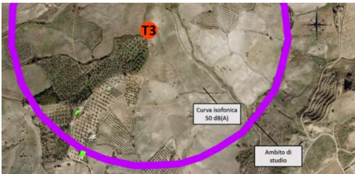
Figura 3-19 Stralcio dell'ambito di studio (viola), della curva isofonica 50 dB(A) e ricettori in prossimità dell'aerogeneratore T3
