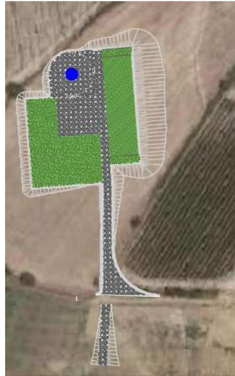
Per tale piazzola è prevista anche la realizzazione di un breve rilevato (lunghezza di circa 33,00 metri e larghezza di circa 4,00 metri) utile al posizionamento a terra della gru tralicciata prima del tiro in alto.
