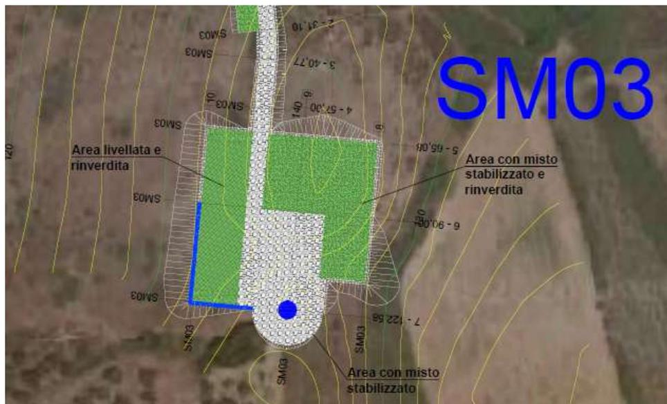
La richiesta conformazione del terreno (sistema piazzola + piccolo tratto in accesso) determinerà lo scavo di circa 8.400 m<sup>3</sup> di materiale, al netto dello scavo delle strutture di fondazione dell'aerogeneratore (pari a circa 1.250 m<sup>3</sup>) ed il posizionamento in rilevato di 3.300 m<sup>3</sup> di materiale oltre a quello impiegato per il rinterro della fondazione.
