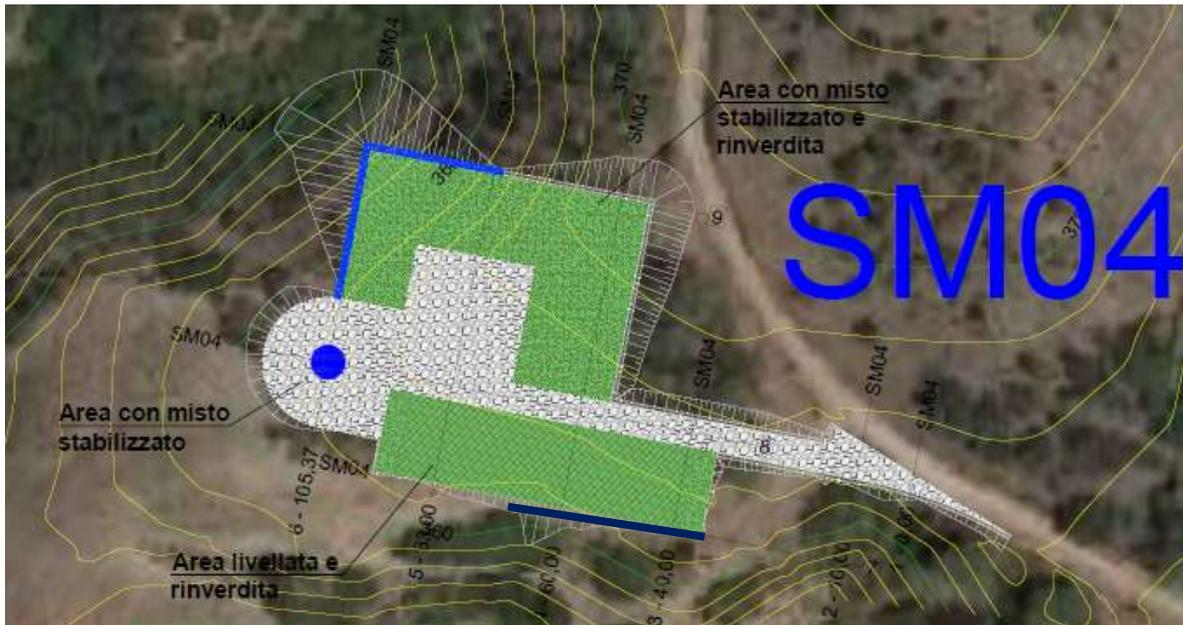
Al fine di aumentare la sicurezza in termini di verifica di stabilità del pendio è stata inserita una paratia lungo il lato nord ovest della piazzola.
