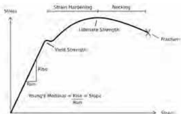
Figura 10 - Diagramma sforzo - deformazione di un materiale duttile
