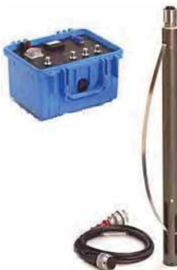
Figura 9 - Geofono da foro triassiale della Geostuff, modello BHG-2
