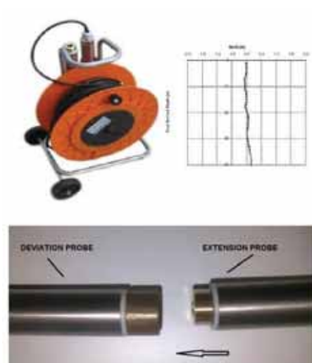
Figura 12 - Sistema di misura verticalità fori – Deviometro Ambrogeo
