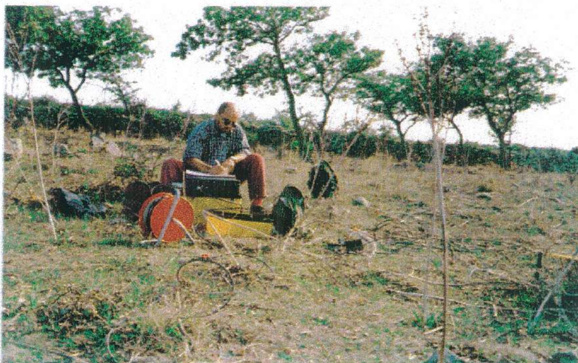
FOTO n° 13 - Linea a rifrazione di dettaglio n° 6 (c/o imbocco galleria). Fase di registrazione dati
