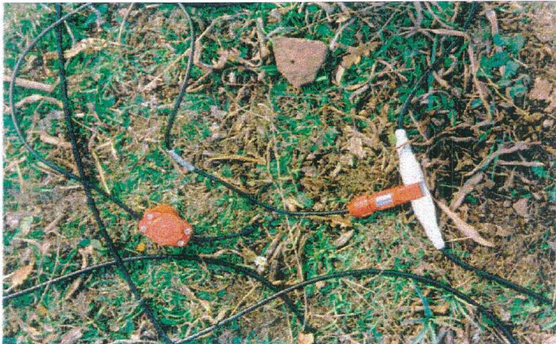
FOTO n° 9 - Geofono 14Hz di linea per acquisizione a rifrazione. Dettaglio sulla connessione al relativo cavo sismico.
