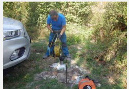
Foto 1 Esecuzione prova down-hole S1-DH
