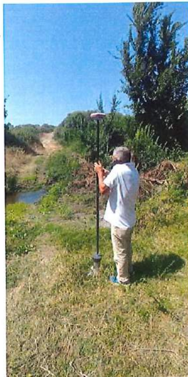
Fig. 3 – Posizionamento del sondaggio mediante stazione GPS
