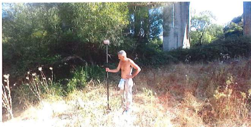
Fig. 3 – Posizionamento del sondaggio mediante stazione GPS
