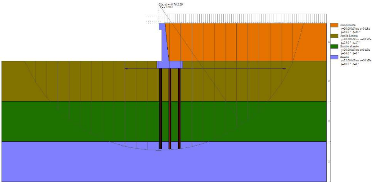
Figura 62 – Verifica in condizioni statiche
