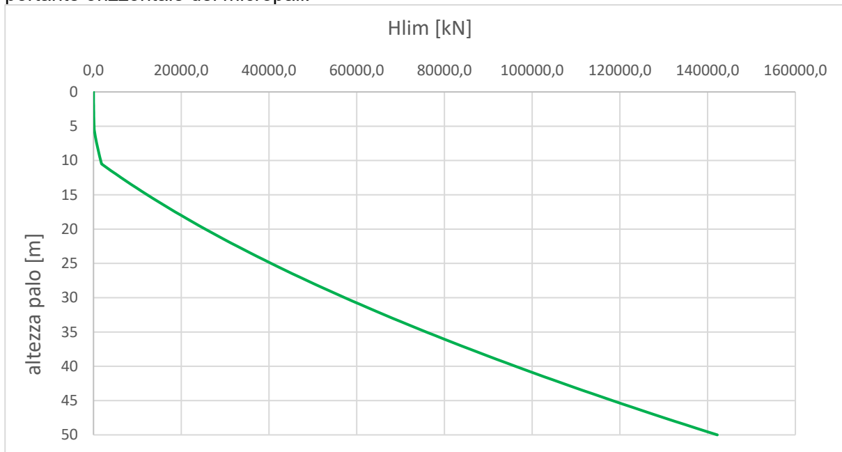
Figura 23 – Curva di capacità portante orizzontale con parametri minimi
