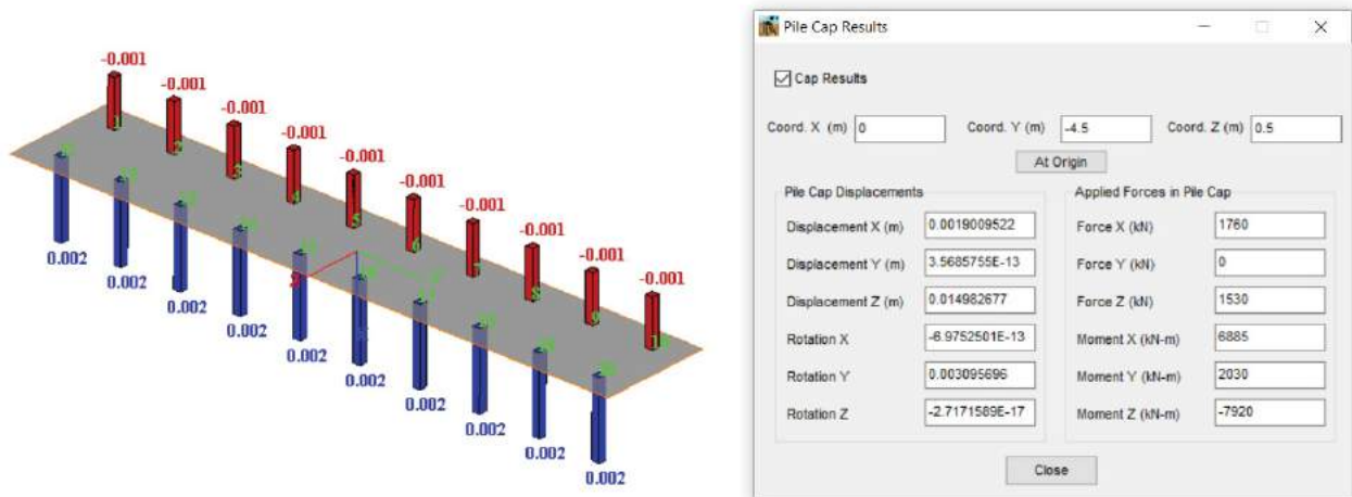
Figura 28 – Cedimenti e rotazioni fondazione
