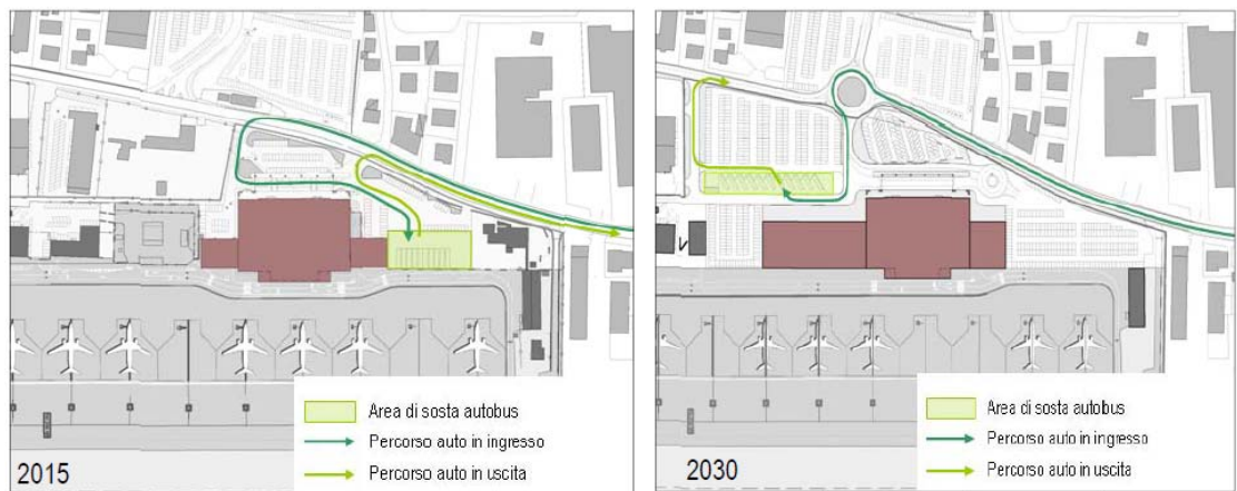
Figura 3-3 Sistema dei percorsi e della sosta auto al 2015 e 2030 (fonte: Aeroporto di Treviso “Antonio Canova” Masterplan: relazione e piano degli investimenti).
