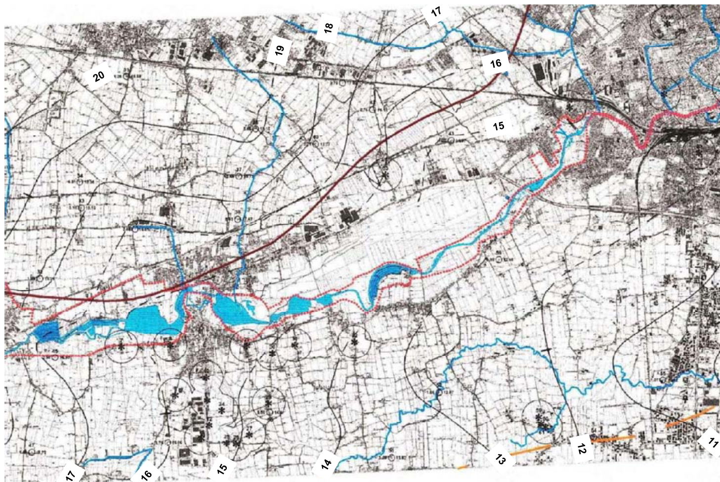
Figura 4-23 Idrogeologia dell'area dell'aeroporto e dintorni. Particolare della tavola n. 14 del Piano Ambientale del Parco Regionale Naturale del fiume Sile. La linea rossa individua il limite settentrionale della fascia delle risorgive; quella arancione il suo limite meridionale. Quota delle isofreatiche o isopiezometriche (a sud del F. Sile) espressa in metri sul livello del mare.
