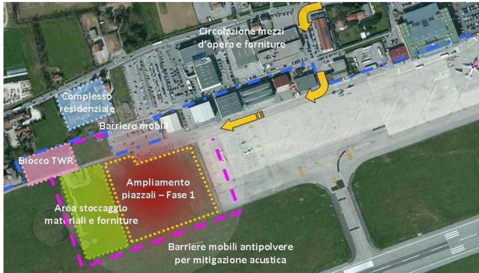
**Figura B5-1 Accessi all'area di cantiere dell'intervento di ampliamento del piazzale aeromobili.**
