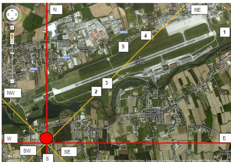
Figura D6-1 Ubicazione dei punti di monitoraggio per la qualità dell'aria. Da 1 a 5 posizionamento radielli, nel cerchio rosso la stazione fissa di Ente Zona.
