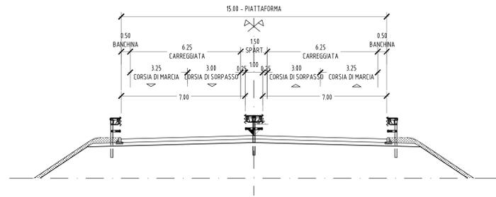
SEZIONE TIPO IN RILEVATO CON AMPLIAMENTO DELLA CARREGGIATA
