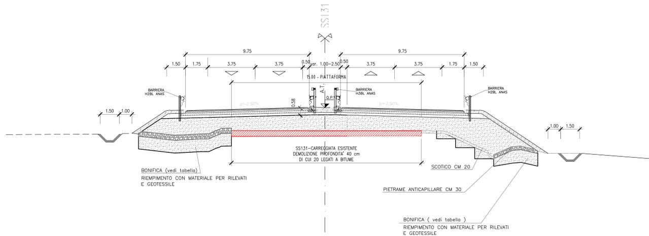
SEZIONE TIPO IN RILEVATO CON AMPLIAMENTO DELLA CARREGGIATA
