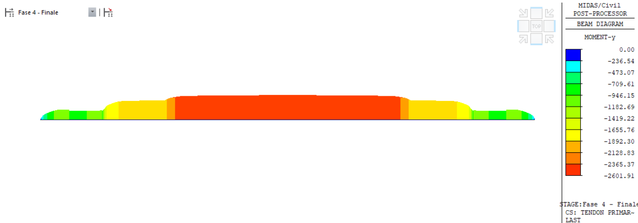
Figura 12-6 Effetto della precompressione – Sollecitazioni di momento flettente
