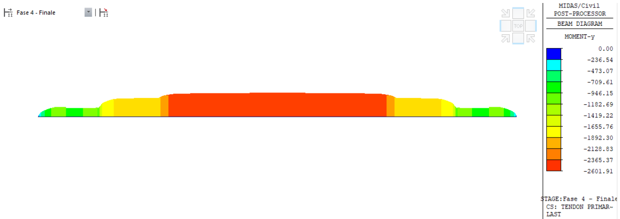
Figura 12-6 Effetto della precompressione – Sollecitazioni di momento flettente – Carreggiata Sud
