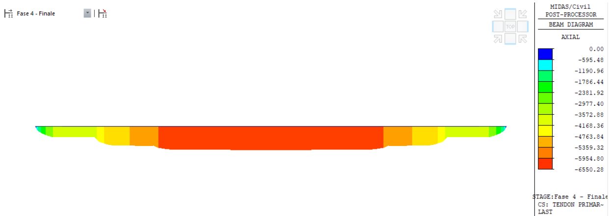
Figura 12-14 Effetto della precompressione – Sollecitazioni assiali – Carreggiata Nord
