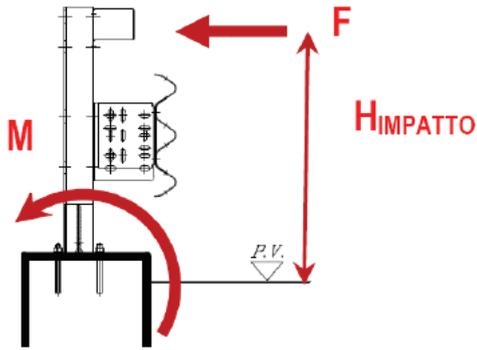
Figura 19 – Schema di calcolo per l'azione di urto
