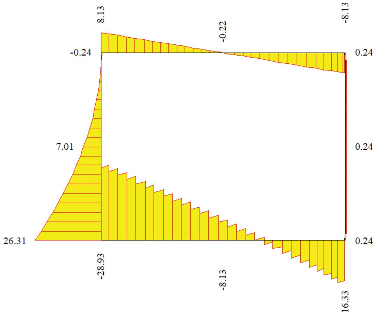
Figura 24 – Involuppo del diagramma del taglio
