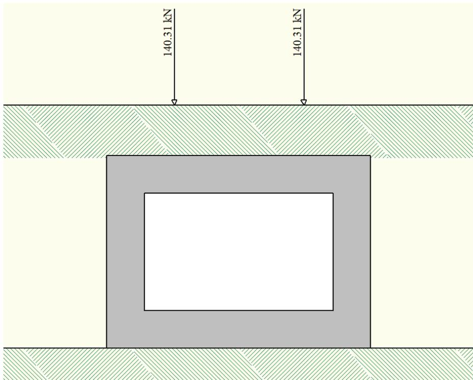
Figura 9 – Gruppo 1 – carico tandem (condizione di carico n°8)
