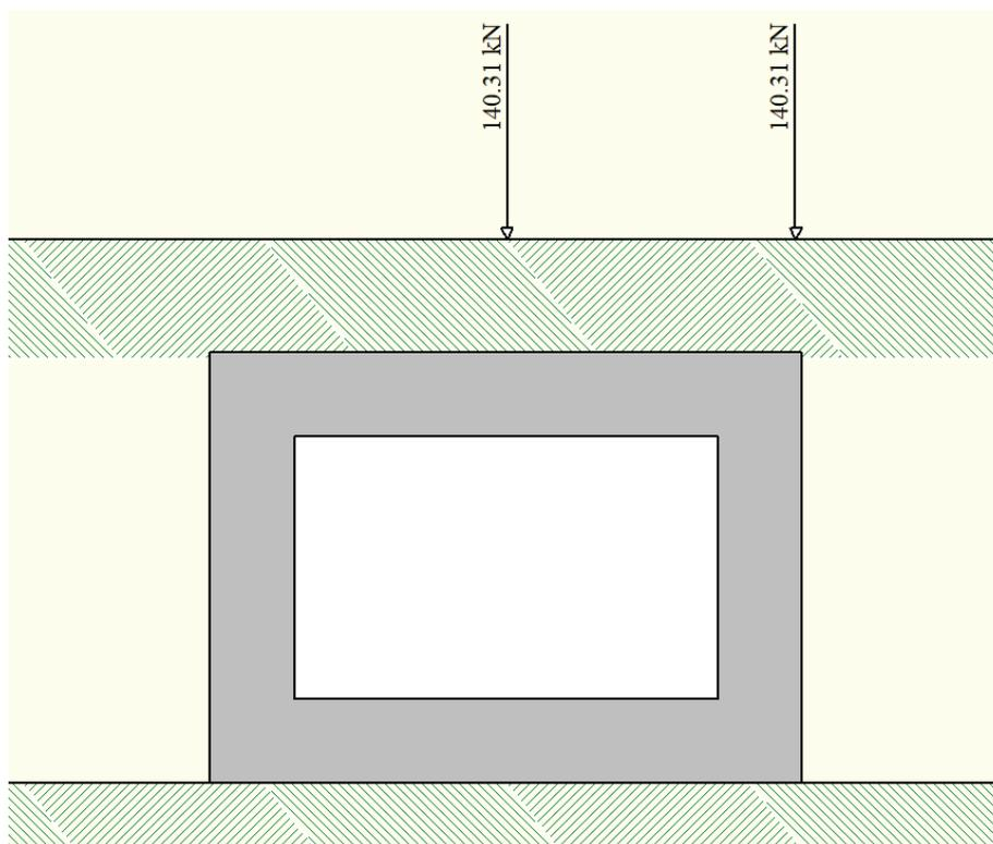
Figura 11 – Gruppo 2 – carico tandem (condizione di carico n°9)
