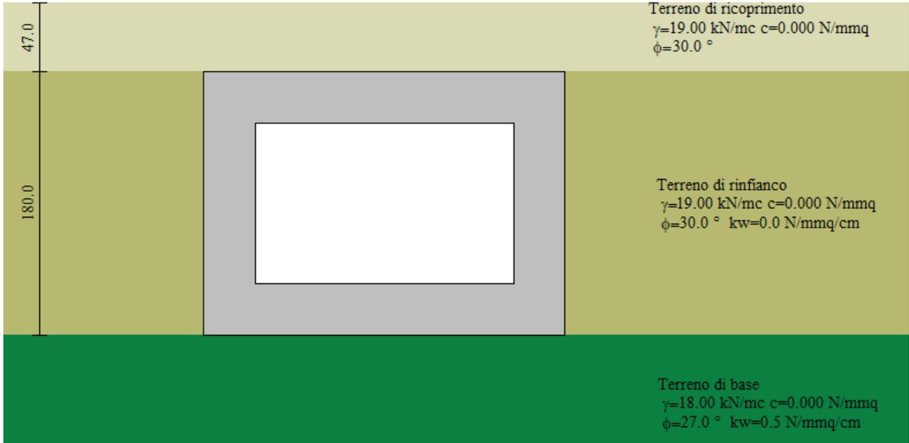
Figura 2 – Stratigrafia e caratteristiche del terreno
