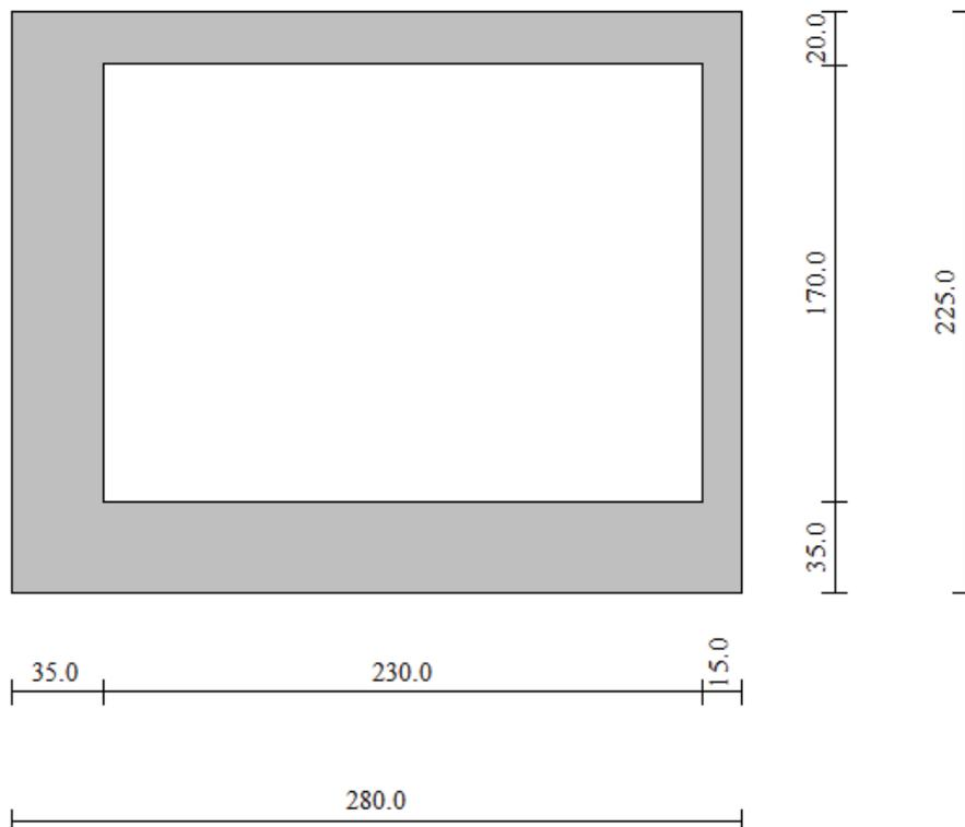
Figura 20 – Geometria del modello agli elementi finiti
