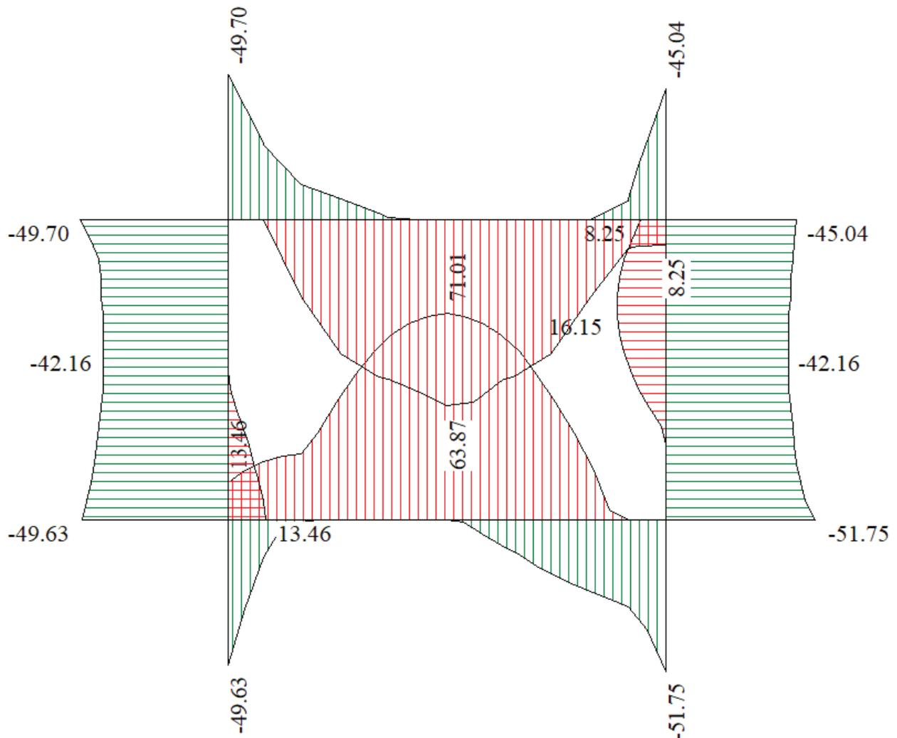
Figura 15 – Inviluppo del diagramma del momento
