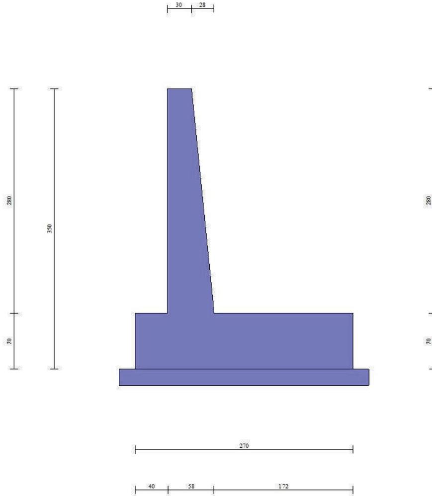
Figura 27 – Geometria del muro d'ala
