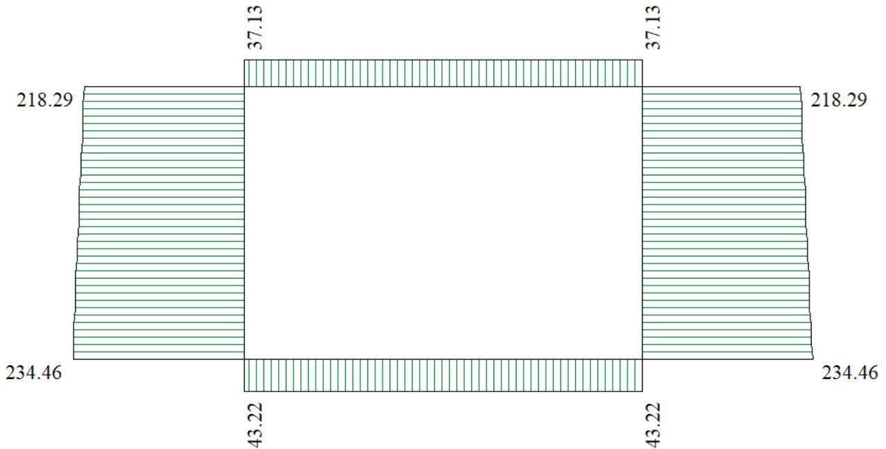
Figura 17 – Inviluppo del diagramma dello sforzo normale
