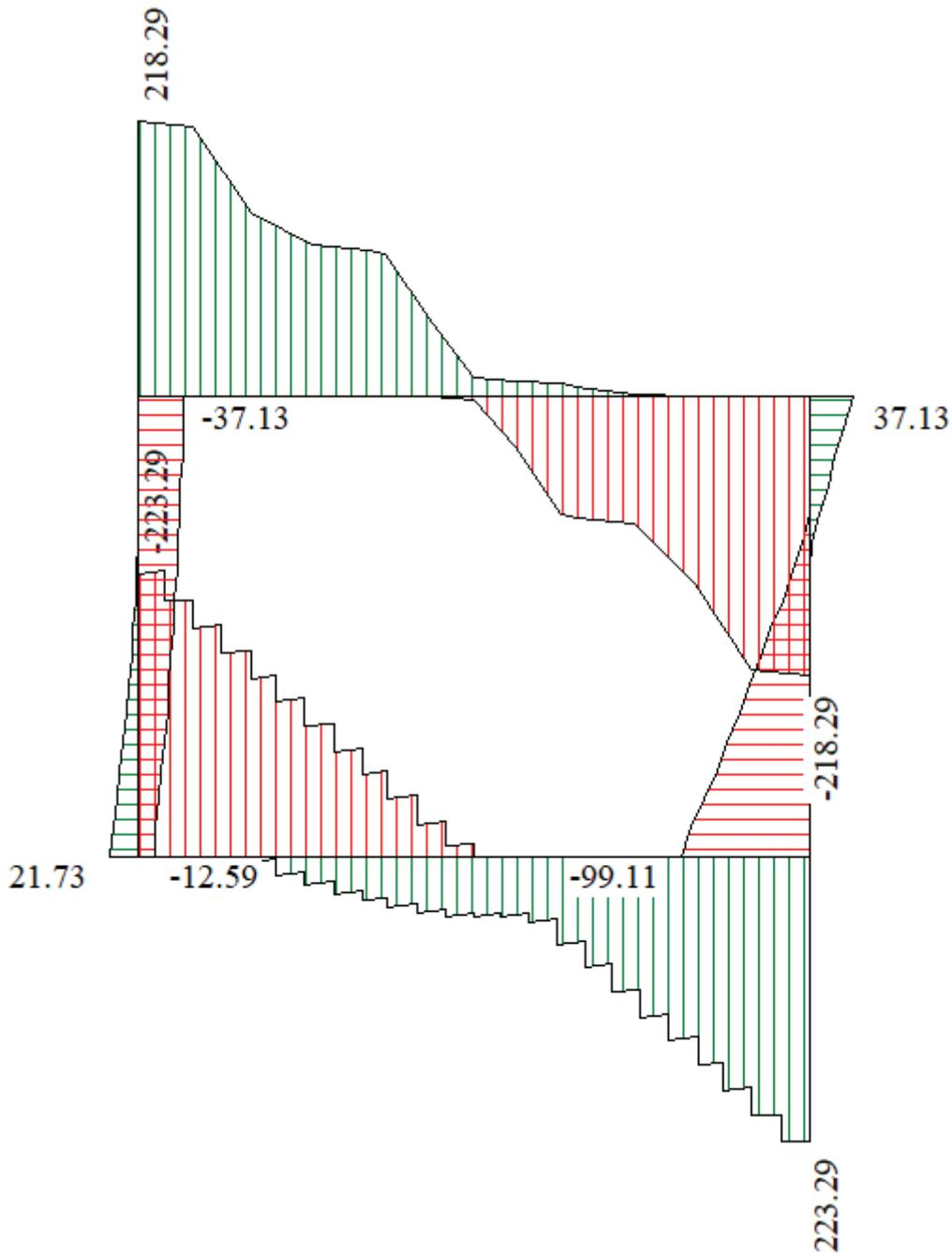
Figura 16 – Inviluppo del diagramma del taglio
