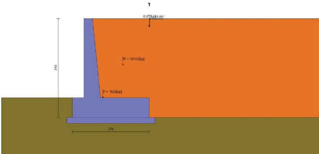
Figura 32 – Cuneo di spinta sismico (Combinazione n° 2)
