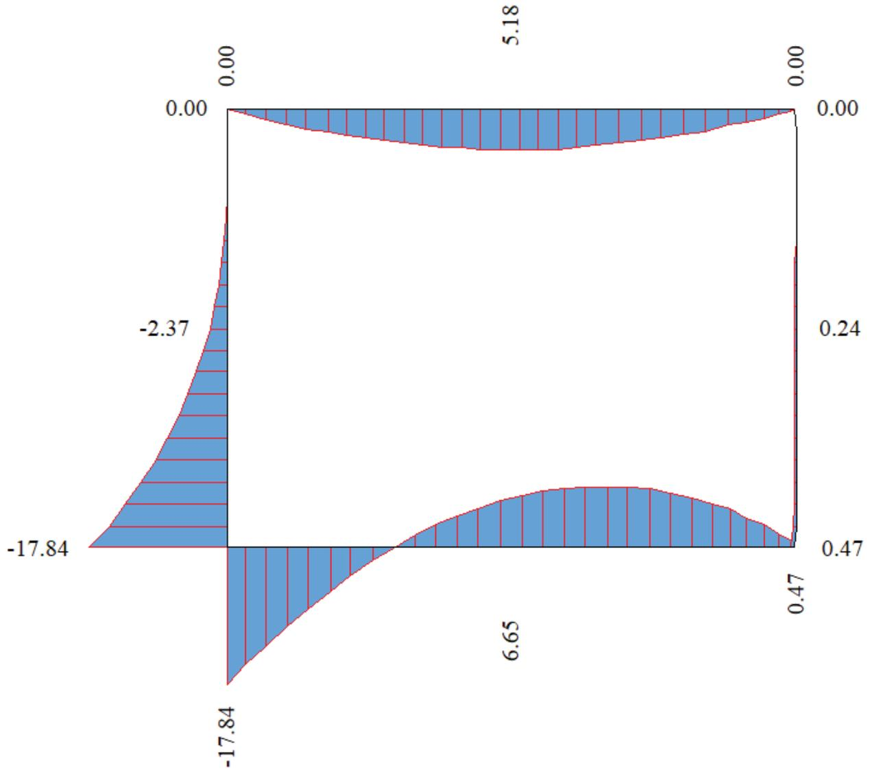
Figura 23 – Inviluppo del diagramma del momento
