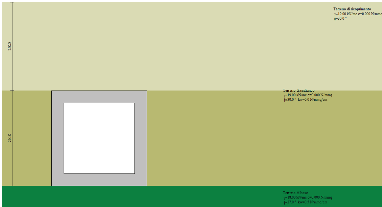
Figura 2 – Stratigrafia e caratteristiche del terreno
