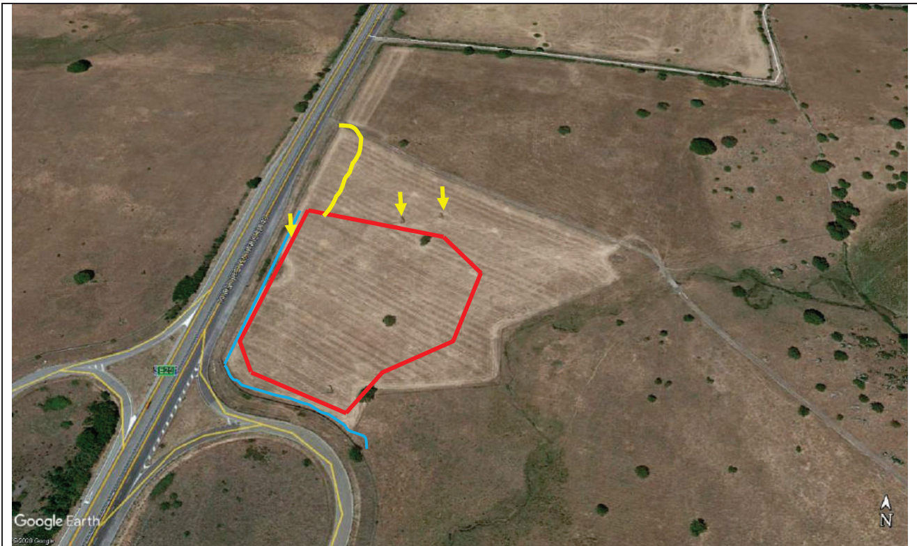
FOTO 12 - Panoramica generale dell'area del Campo Operativo CO.05 (perimetro in rosso); in giallo è invece riportato l'accesso dalla rampa di collegamento sulla SS131 con la relativa pista. Le frecce in giallo indicano i sostegni metallici della linea elettrica in MT (esterni al perimetro del campo operativo). La linea ciano individua i muri in pietrame a secco che saranno mantenuti esterni al perimetro del cantiere.
