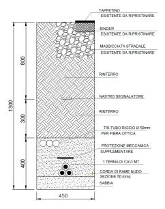
Lungo tutto lo scavo dei collegamenti tra gli aerogeneratori sarà posata una corda in rame nudo di sezione 50 mm² per la messa a terra dell'impianto.
