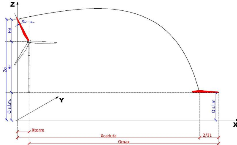
Figura 2 - Modello geometrico del distacco della pala intera
