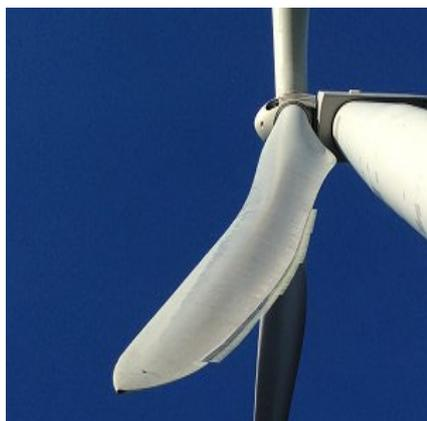
Il sistema di controllo di passo è un particolare dispositivo che permette la rotazione delle pale in maniera tale da consentirne un adattamento ottimale in funzione del vento. In particolare, per la fase di frenatura le pale sono ruotate di 90° rispetto al proprio asse, il che genera una resistenza all'aria altissima, che induce alla frenatura del rotore (freno aerodinamico).
