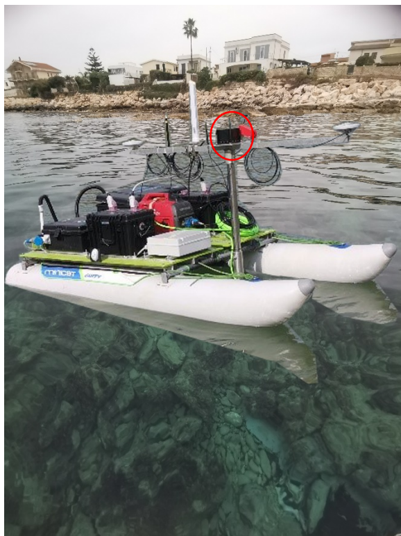
Figura 22 – MRU installato sul palo del MBES utilizzando un'apposita flangia regolabile che consente di ottenere vari gradi di inclinazione a step di 15°. In figura: da sinistra a destra, installazione classica con testa in posizione normale (usata in questo caso) e installazione con testa inclinata con angolo di 45°.
