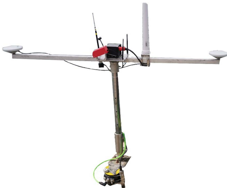
Figura 23 – Installazioni strumentali esemplificative a bordo dell'imbarcazione "ASV" impiegata nell'esecuzione del rilievo Mbes. Si noti in dettaglio il sistema di "Frame" realizzato e tarato ad hoc per l'installazione di tutti i sensori della piattaforma inerziale INS Applanix e del sistema Mbes M3 Kongberg
