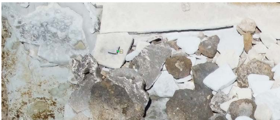
Figura 22 - Posizionamento manuale dei GCP e loro proiezione nelle foto (bandierina verde)
