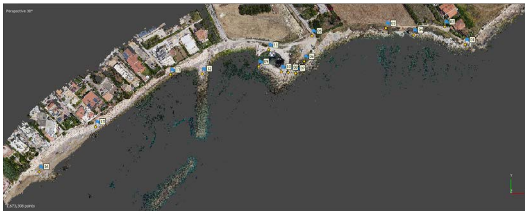
Figura 23 - Correzione della nuvola sparsa mediante l'utilizzo dei GCP precedentemente posizionati
