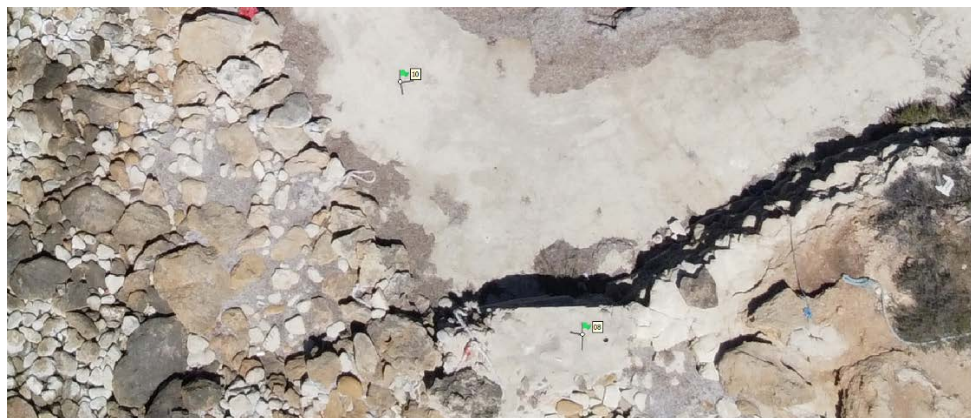
Figura 20 - Posizionamento manuale dei GCP e loro proiezione nelle foto (bandierina verde)
