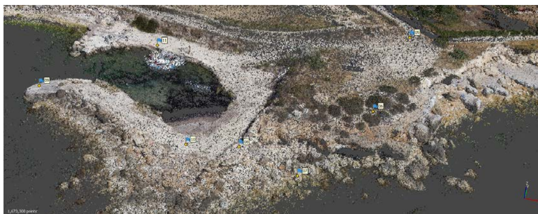
Figura 24 - Correzione della nuvola sparsa mediante l'utilizzo dei GCP precedentemente posizionati
