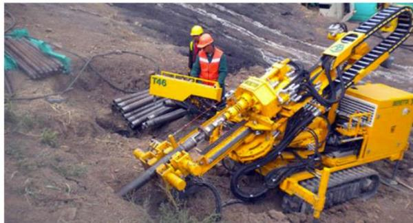
Figura 4. Sonda perforatrice Beretta T-46.
