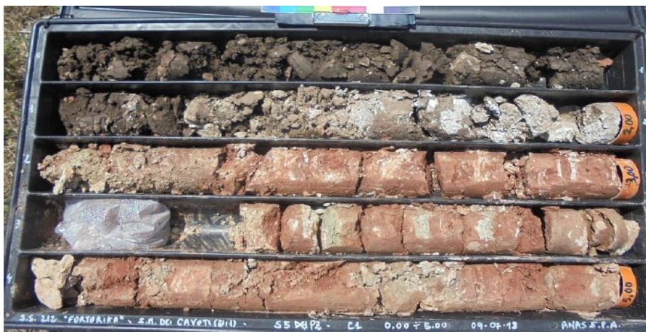
Fig. 4-7 Particolare delle argille rosso-brune alterate (FYR 3b) carotate nel sondaggio S5pz tra 0 e 5 m di profondità.
