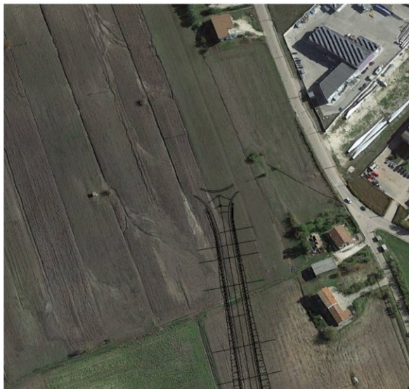
Fig. 5-3 Particolare della forte azione erosiva concentrata a rivioli e solchi di ruscellamento, verificatisi nelle aree prossime al tracciato di progetto in seguito delle forti piogge dell'Aprile del 2015.
