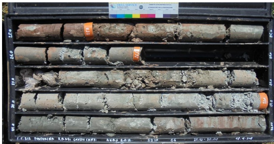
Fig. 4-9 Particolare delle argilliti grigio verdognole e marne (FYR 3a) carotate nel sondaggio S2in tra 25 e 30 m di profondità.
