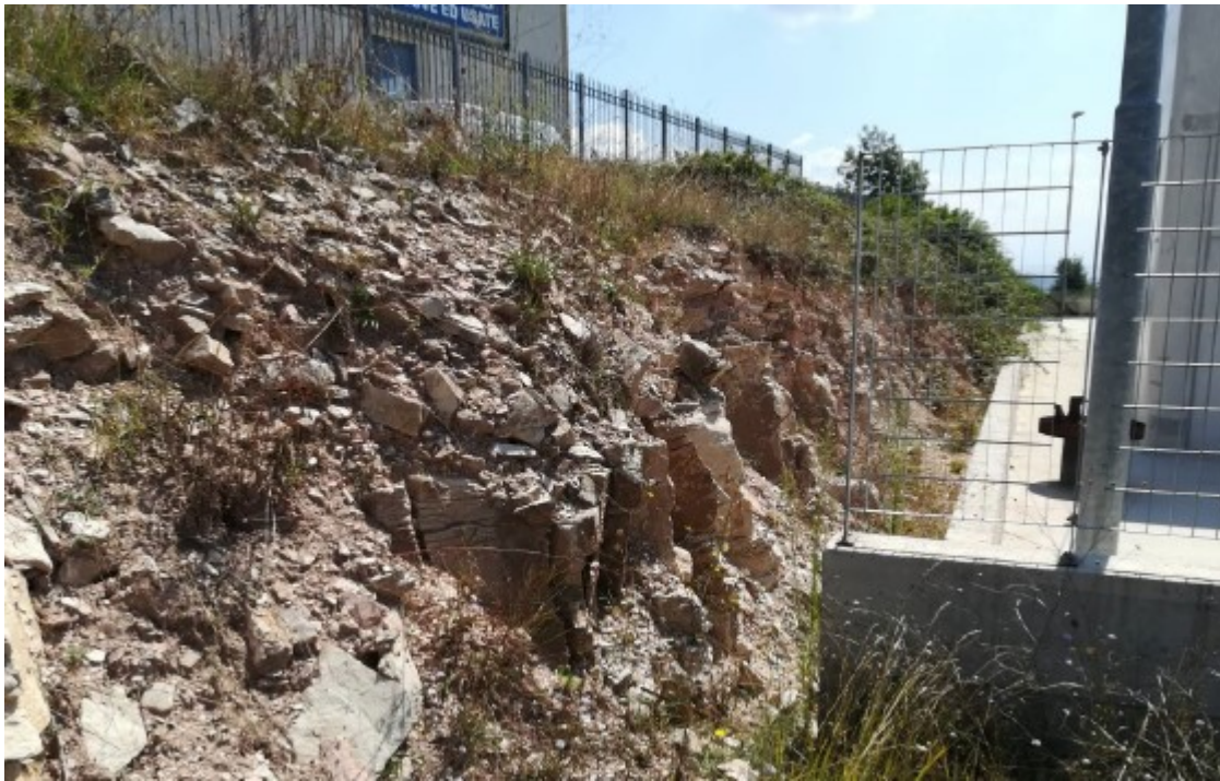
Fig. 4-8 Calcari e calcari marnosi stratificati, in strati da sottili a spessi, di colore biancastro con intercalazioni di marne e argille marnose, rosso vinaccia e rosate riferibili alla Flysh rosso (FYR3), affiorante ad est del tracciato in progetto (scheda rilevamento GEO-06)
