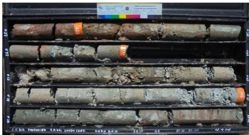
Figura 33 Particolare delle argilliti verdastre caoticizzate (FYR 3a) carotate nel sondaggio S2 in tra 25 e 30 m di profondità.
