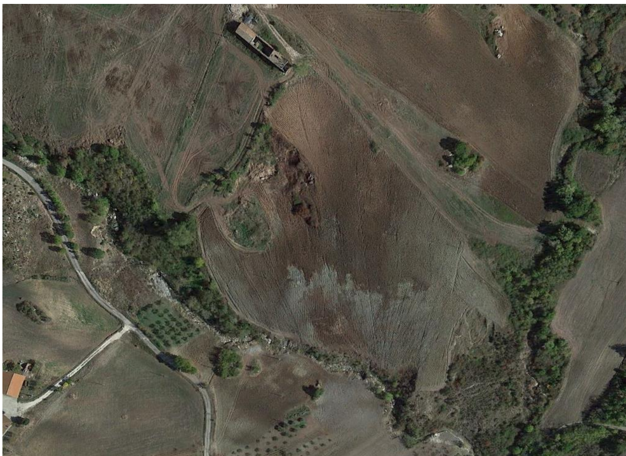
Figura 6-38 Vista dall'alto dell'areale di affioramento delle compagini argillose policrome riferibili alla Formazione delle Argille Varicolori del Fortore, presente ad ovest dell'area rilevata.
