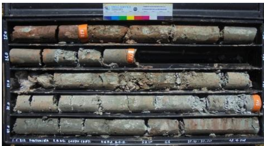
Figura 6-35 Particolare delle argilliti verdastre caoticizzate (FYR 3a) carotate nel sondaggio S2in tra 25 e 30 m di profondità.
